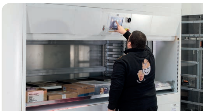
Console à écran tactile et tableau électrique intégré
